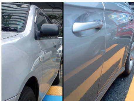
Fig.2 – Superfici in Classe A, nel mondo dell'auto, definiscono il livello qualitativo del prodotto finale; piccole variazioni della superficie si traducono in un'anomala riflessione delle immagini
